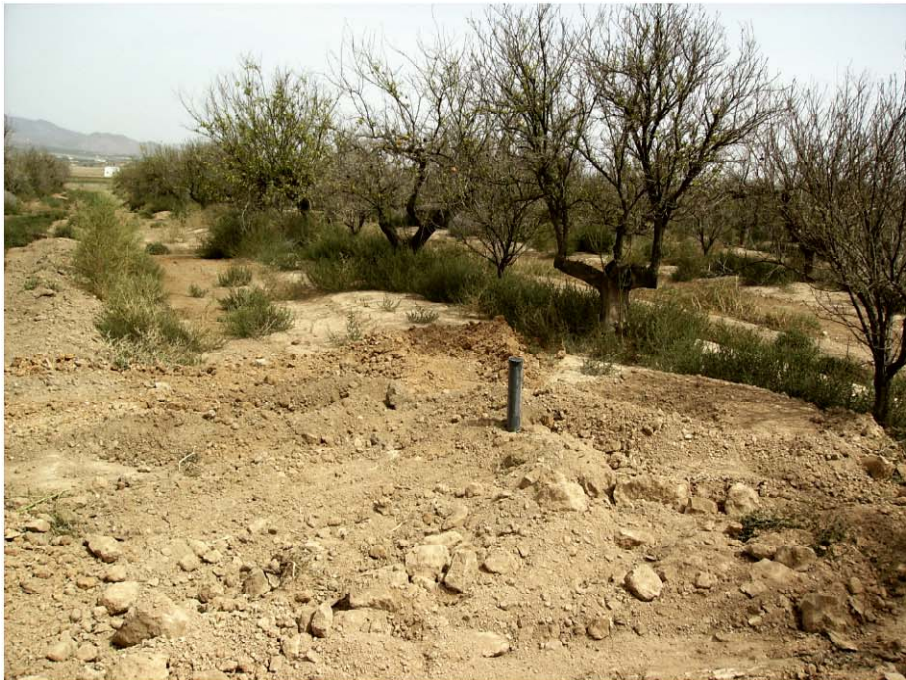
PIEZÓMETRO EN CALICATA C-3
