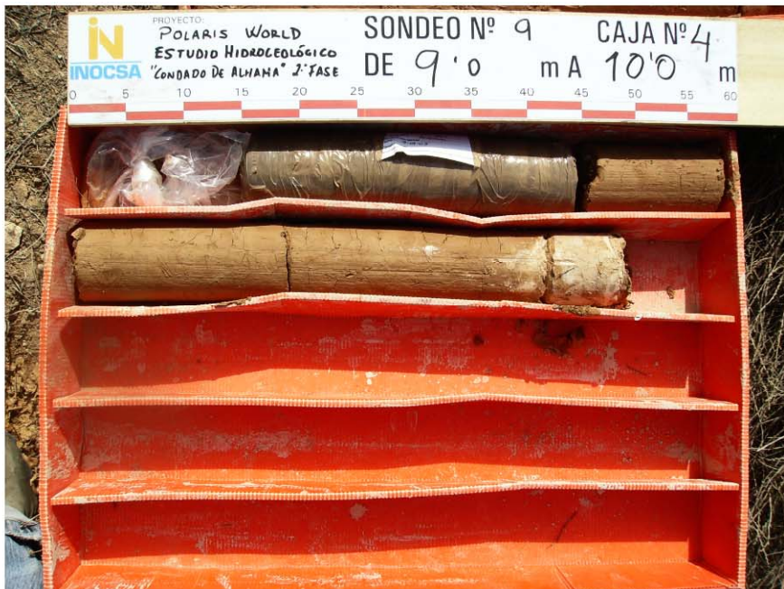
CAJAS DE TESTIGOS DEL SONDEO S-9 (6,0-10,0)
