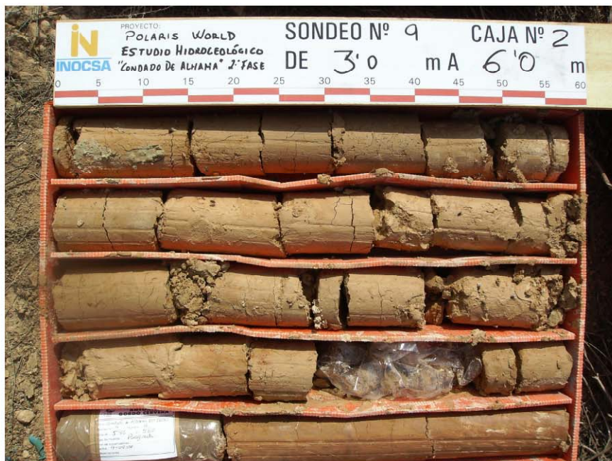
CAJAS DE TESTIGOS DEL SONDEO S-9 (0,0-6,0)
